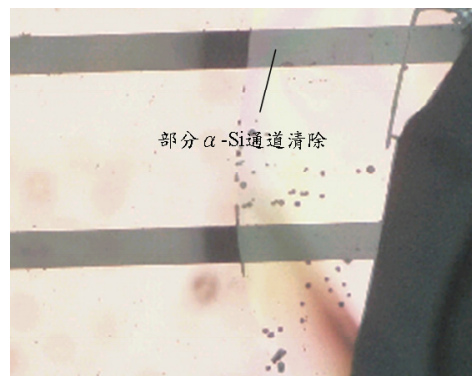
圖五 經過 1.5 小時的 KOH 的超音波的振盪，部分 \alpha -Si 通道清除 子計畫：光記錄媒體材料、性質及其應用於光碟記錄容量提升之研究
