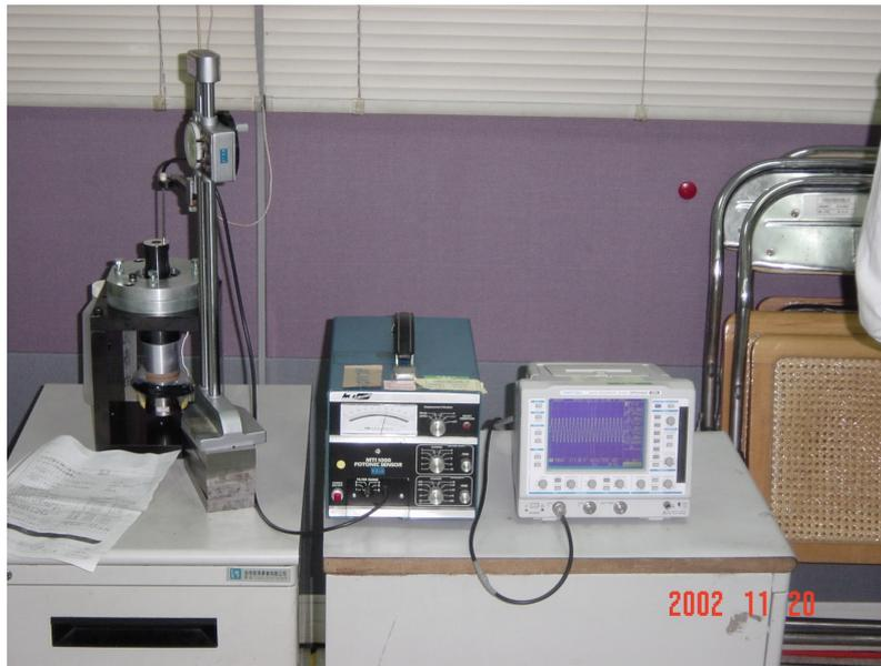
圖 三 超音波振動頻率與振幅之量測裝置
