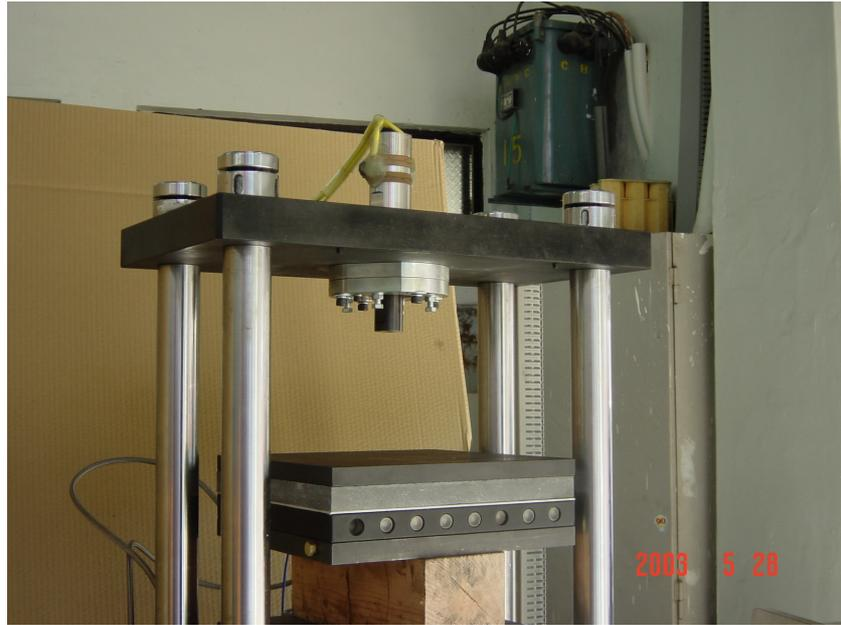
圖七 超音波振動成形之實驗裝置
