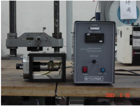
圖 2 超音波頻率產生器與換能器
