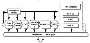
隨著去年新一代的音訊壓縮和解壓縮技術 MPEG4- T/F Coding 的定義,和所帶來的更強大 壓縮功能,可以預料的是將會是未來音訊研究 和未來產品的核心技術。本研究基對音訊壓縮 標準 MPEG4- T/F Coding 做理論探討和軟體系 統實做。
