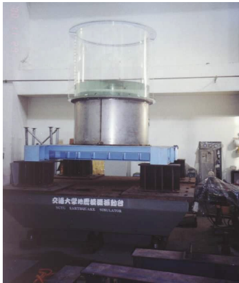
圖 2(a) 置於振動台上之模型實體
