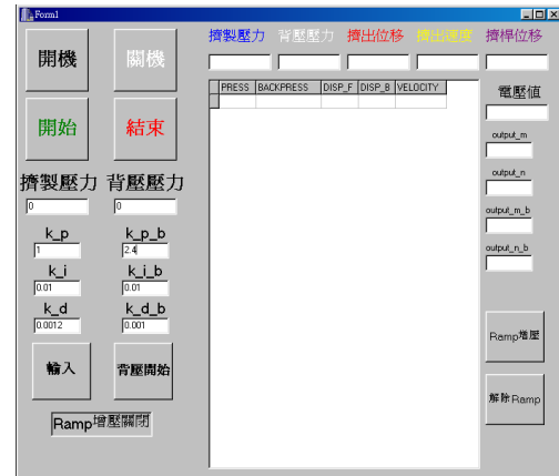
圖二 控制軟體之操作介面 本研究中所設計之控制軟體操作介面，可監測擠製過程中之各項參數、不同之給壓方式、PID 控制支各項參數等。
