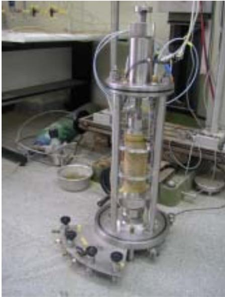
圖二 應變控制往復式三軸試驗裝置
