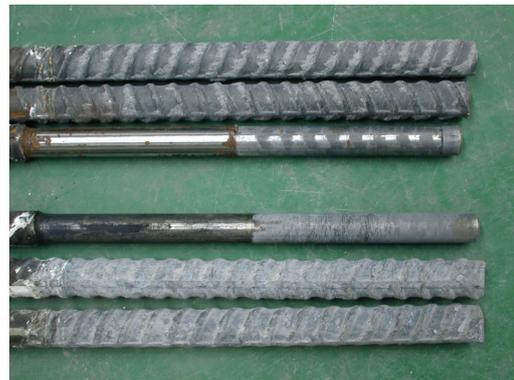
圖二 鑄筋混凝土接觸面比較
