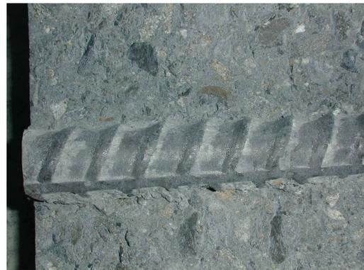
圖三 標準組鑄筋表面
