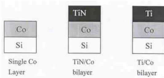
圖一 鈷矽化物的堆疊結構。
