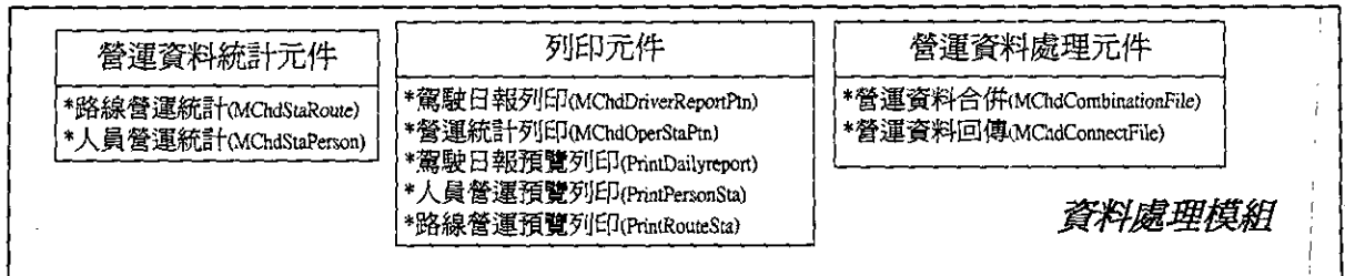
圖 3.8 資料處理模組架構示意圖
