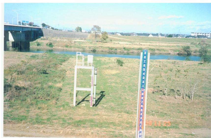
圖 3-16 洪水平原內依照階梯狀河床擺設的水尺
