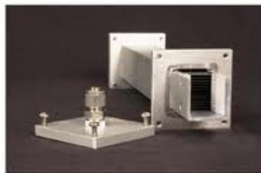
圖 3.13 平行平板式碳濾紙固氣分離器。
