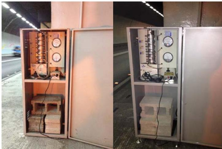
圖 4. 70 雪山隧道 MOUDI 採樣現場照片，左(26.4KM、入口處)、右(17.5KM、出口處)。
