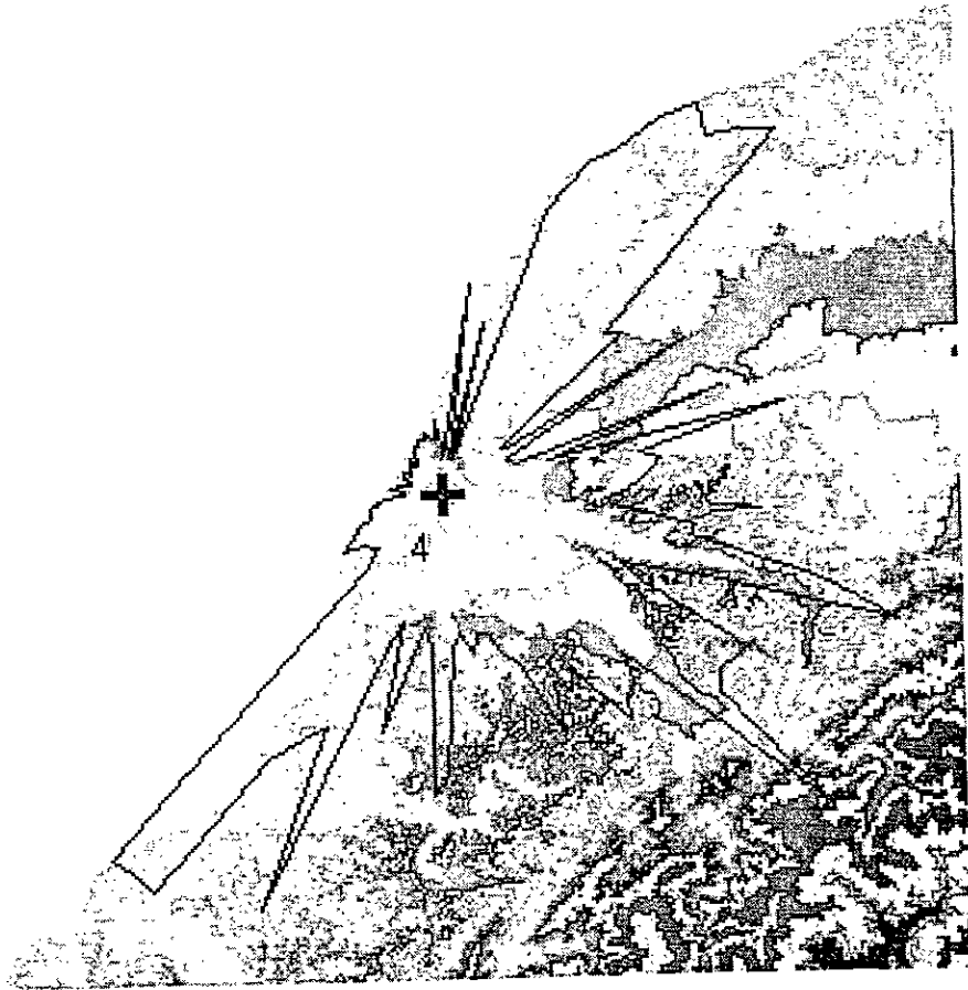
圖 3.17 以新竹湖口轉播站發射站址所預估之有效涵蓋面積，這裏 \alpha=90 及 E_{th}=36 dBu/m。
