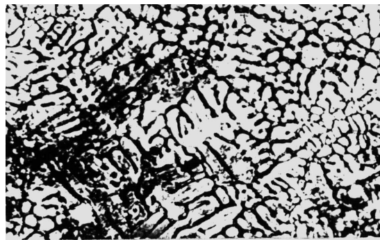
圖 4-8 316 不銹鋼鐳道的等軸樹枝狀結構 (X 400)
