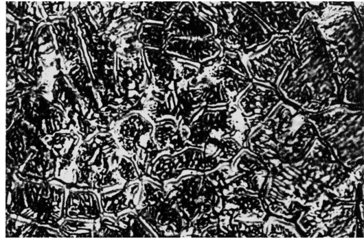
圖 4-5 316 不銹鋼鐳道的細胞狀結構(X 500)
