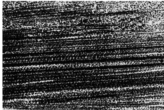
圖 4-7 316 不銹鋼鐳道的樹枝狀結構(X 200)
