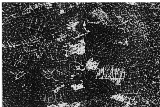
圖 4-20 銲道中心之中心線型結構(X50)
