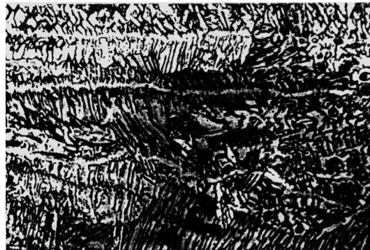
圖 4-6 316 不銹鋼鐳道的又長又大的樹枝臂 (X 400)
