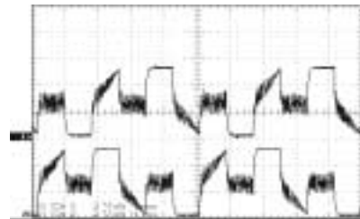
圖 13 U、V channel 經低通濾波器所得波形。
