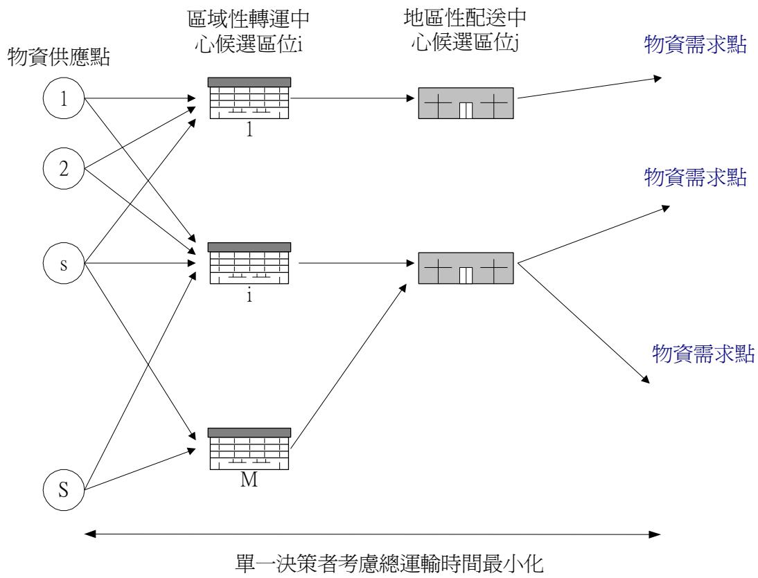
圖 11 一階規劃物流系統示意圖
