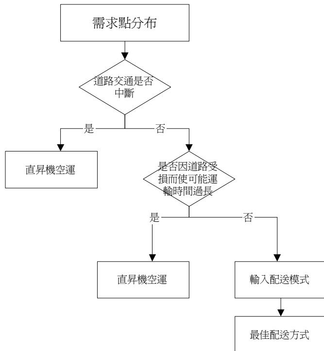
圖 8 各需求點運輸方式選擇示意圖
