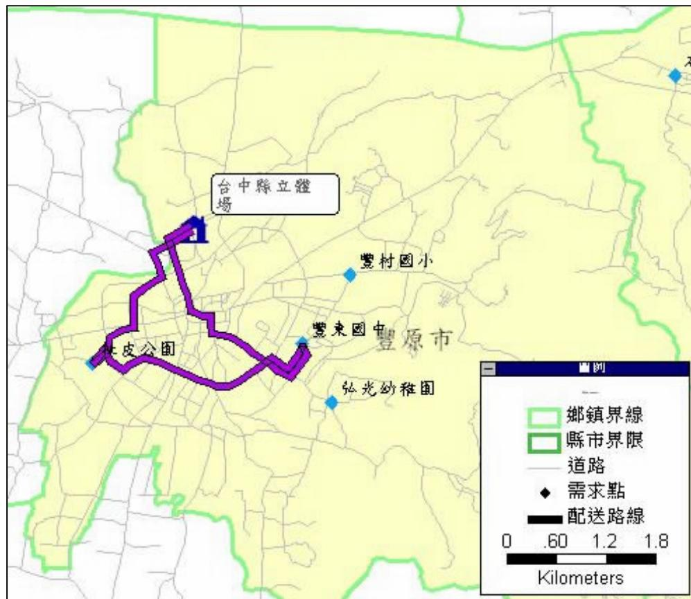
圖 27 小型車輛多點迴圈式配送路線示意圖
