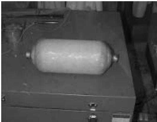
圖（一）纏繞式壓力容器
