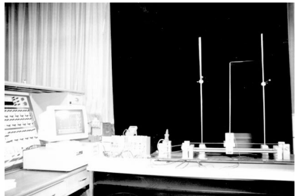
圖(十三) 總計畫整合之倒單擺實驗系統
