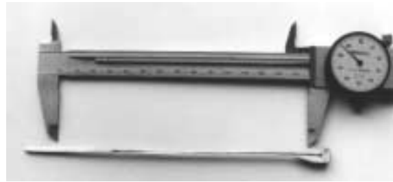
圖七 內徑 3mm 之擠製結果實體剖面圖
