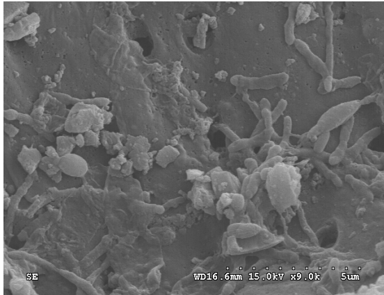
圖六 填充前之菌體固定化顆粒活性濾料表面電顯圖(9,000×)
