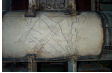
圖六 試體 ICP-J2 交會區剪力破壞
