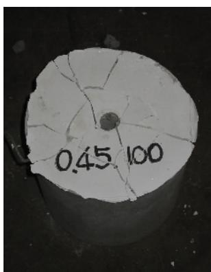
圖(八) 100°C下之破壞面
