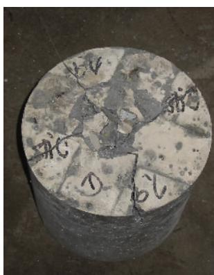
圖(七) 常溫下之破壞面
