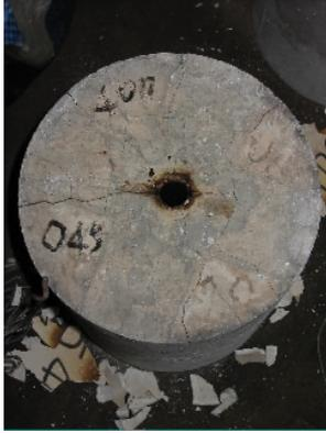
圖(十)400°C之破壞面
