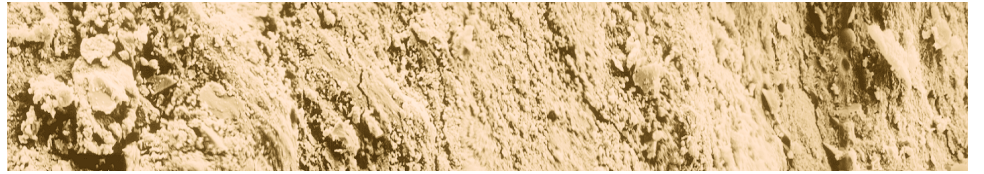
石灰水中養護 1 天加速腐蝕後微觀晶相
