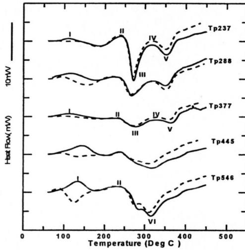
圖 4 2091 鋁合金模擬鋸接熱影響區經 7 天及 30 天自然時效之 DSC 掃瞄結果（虛線 7 天自然時效，實線 30 天自然時效）
