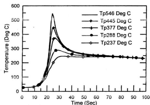
圖 1 鍂接熱影響區所量測之溫度熱循環
