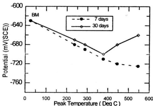
圖 6 2091 鋁合金模擬錄接熱影響區之孔
