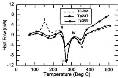
圖 2 2091 鋁合金母材, Tp237 及 Tp288 經 30 天自然時效之 DSC 掃瞄結果
