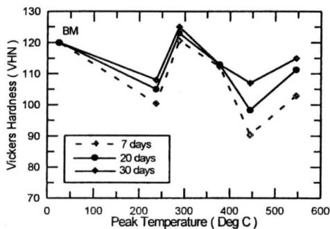
圖 5 2091 鋁合金模擬錄接熱影響區經 7 天，20 天及 30 天自然時效之微硬度
