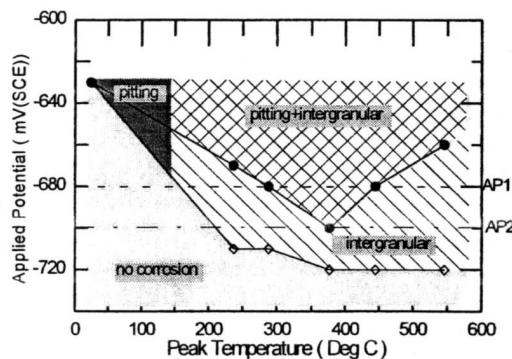
圖 7 定電位下母材及熱影響區之峰值溫度對腐蝕型態之變化
