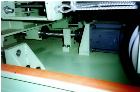
圖 2 電動式伺服馬達主動質塊制動系統
