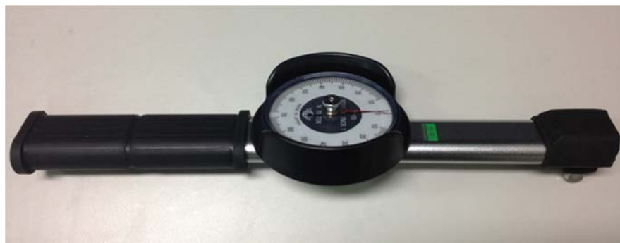
圖 33 扭力扳手(10-70 n.M、3% error rate)
