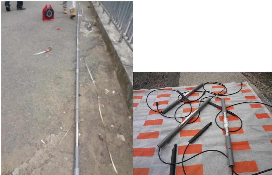
圖 3 微機電串接形式水壓計
