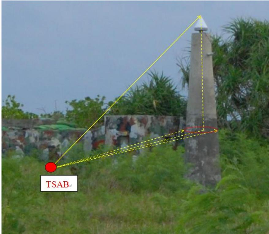
圖 2-4 檢測天線中心是否位於天線柱中心線示意圖
