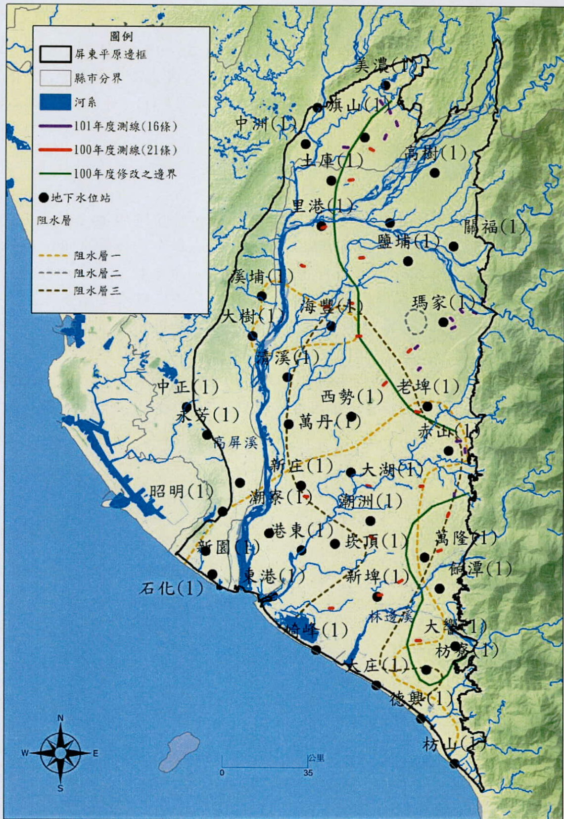
圖 3.1-2 屏東平原各阻水層分布區示意圖
