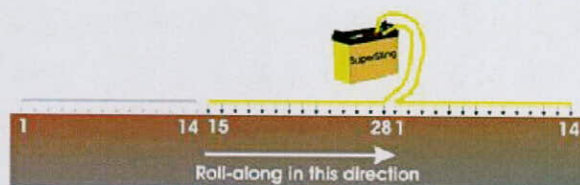
圖 4.1-5 二維地電阻剖面影像探測示意圖
