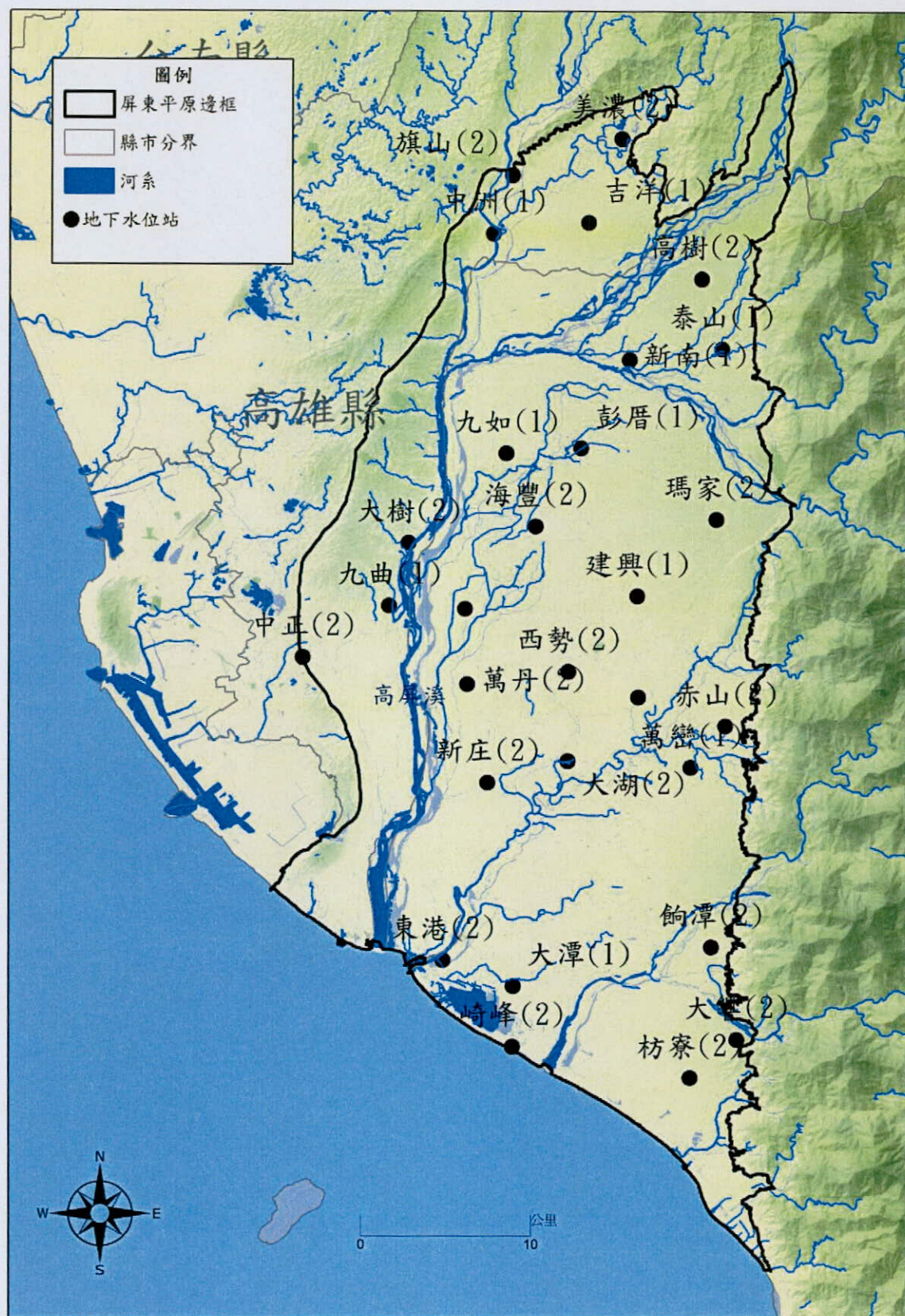
圖 3.2-2 含水層二(F2)地下水觀測井分布圖
