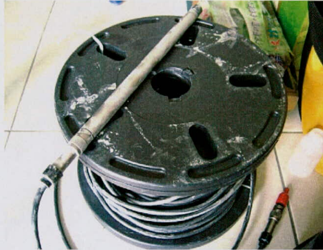
圖 4.2-2 美國 In-situ Troll-200 水壓水溫導電度三合一自記測棒
