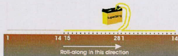
圖 4.1-5 二維地電阻剖面影像探測示意圖
