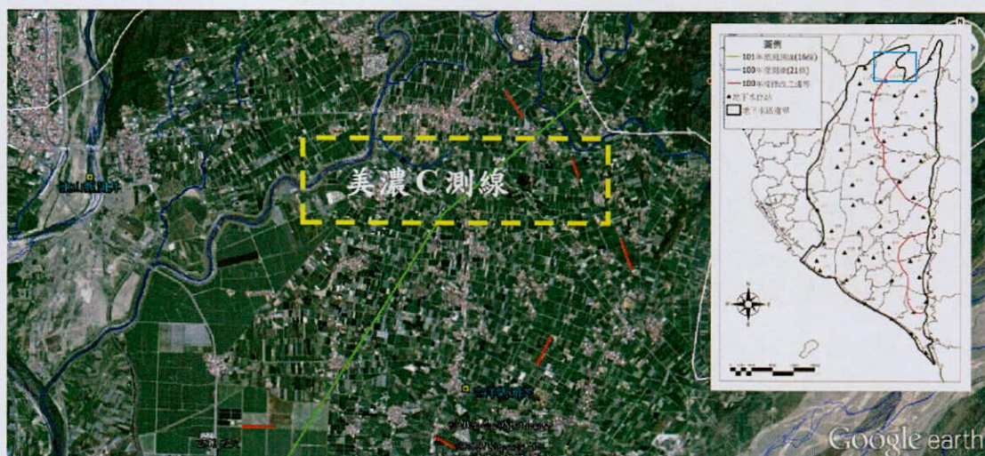
圖 3.1-30 美濃 C 測線之佈設位置圖。施測方式選用 Wenner 方法。黃色虛線圖框中對應藍色框位置。
