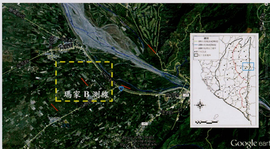
圖 3.1-37 瑪家 B 測線之佈設位置圖。施測方式選用 Wenner 方法。黃色虛線圖框中對應藍色框位置。
