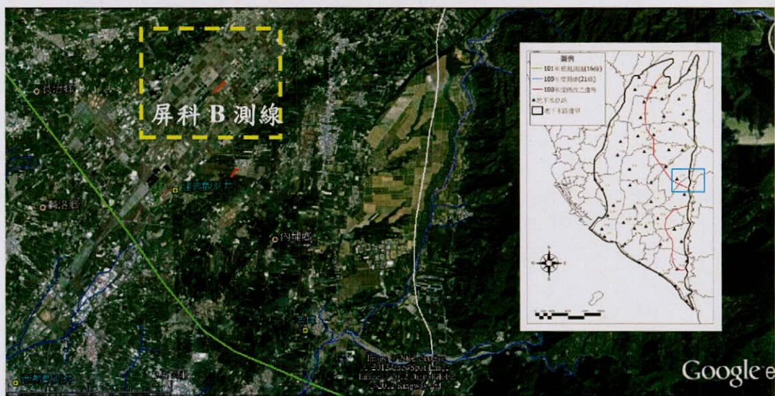
圖 3.1-22 屏科 B 測線之佈設位置圖。施測方式選用 Wenner 方法。黃色虛線圖框中對應藍色框位置。
