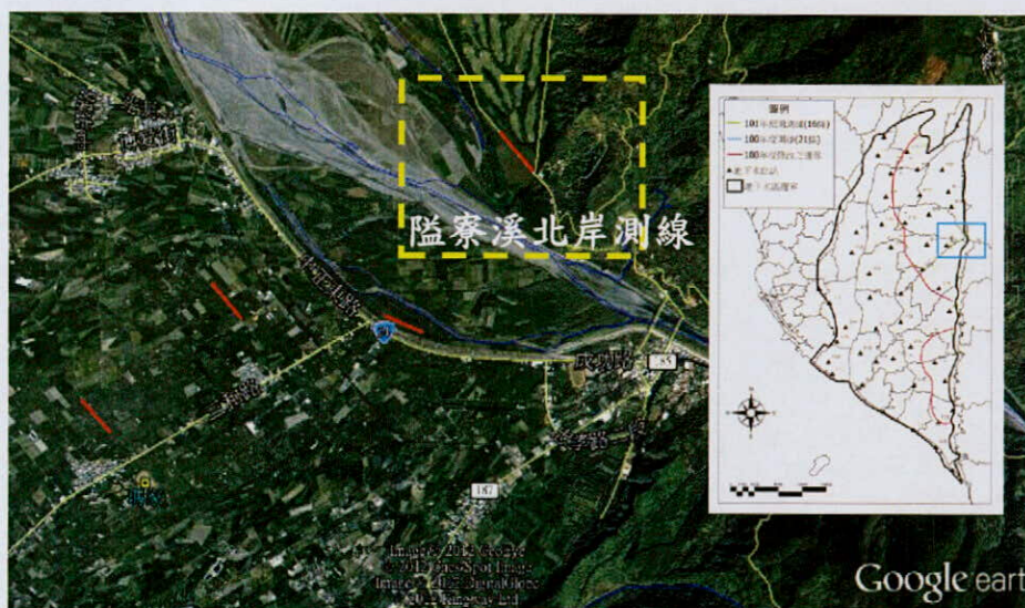
圖 3.1-43 隘寮溪北岸測線之佈設位置圖。施測方式選用 Schlumberger 方法。 黃色虛線圖框中對應藍色框位置。
