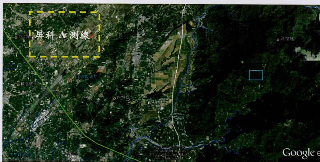
圖 3.1-20 屏科 A 測線之佈設位置圖。施測方式選用 Wenner 方法。黃色虛線圖框中對應藍色框位置。
