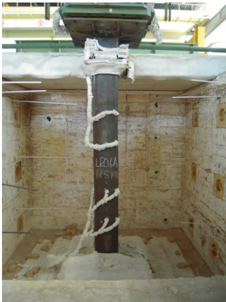
圖 4-6 試體 LR0.6-A 耐火試驗後之外觀
