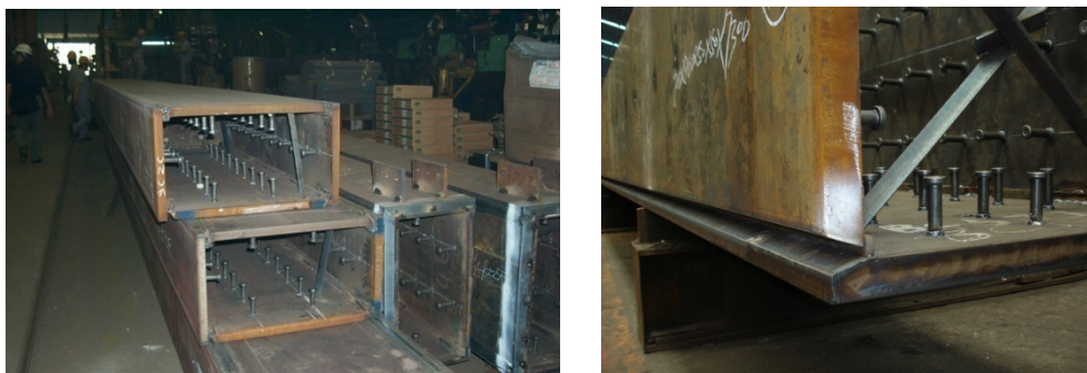
圖 1-3 內灌混凝土箱型柱
