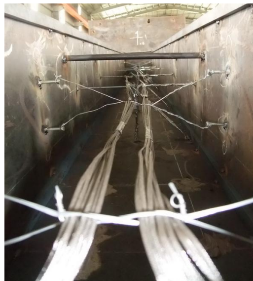
圖 3-4 試體內部熱電偶之安裝
