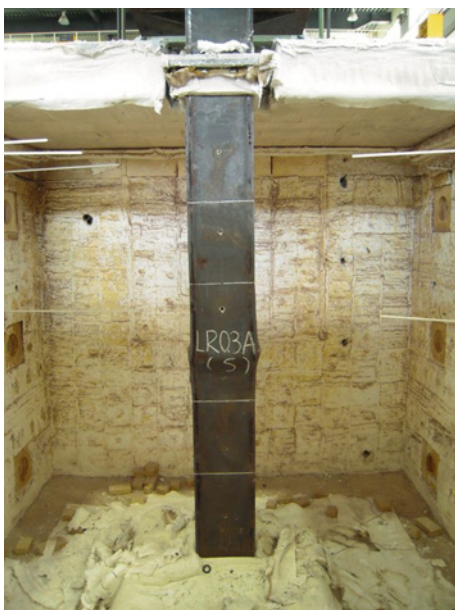
圖 4-19 試體 LR0.3-A 耐火試驗後之外觀
