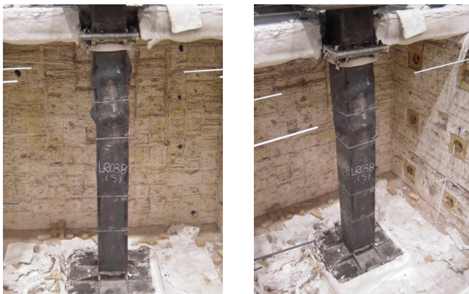
圖 4-25 試體 LR0.3-B 耐火試驗後之外觀
