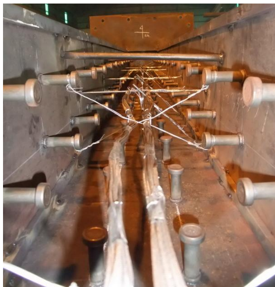
圖 3-4 試體內部熱電偶之安裝
