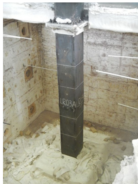
圖 4-19 試體 LR0.3-A 耐火試驗後之外觀
