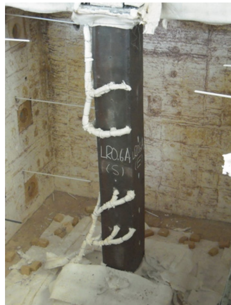
圖 4-6 試體 LR0.6-A 耐火試驗後之外觀
