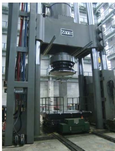
圖 A-1 30 MN MTS 萬能試驗機
