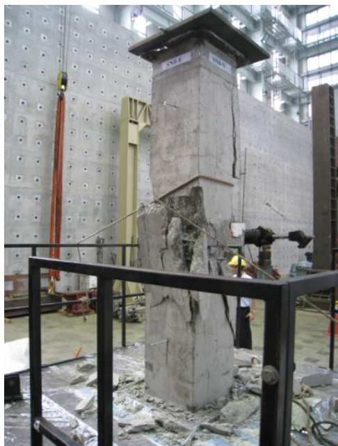
圖 A-2 試體 SN0 載重試驗破壞情形
