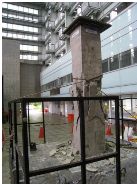
圖 A-2 試體 SN0 載重試驗破壞情形
