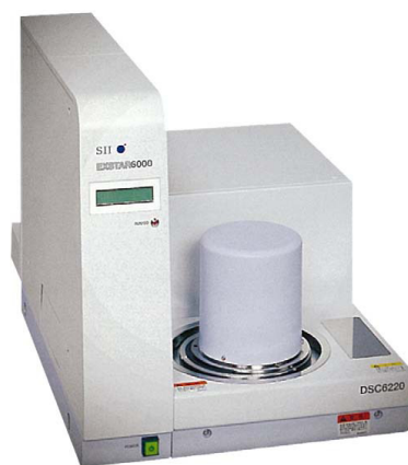
圖 2-1 示差掃描熱量分析儀(DSC)
