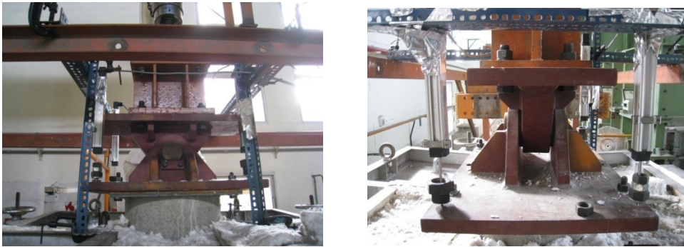
圖 3-13 柱頂端位移計架設
