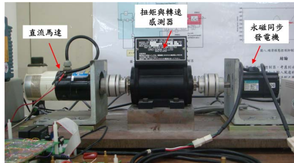
圖 5.1 永磁同步風力發電機實驗平台
