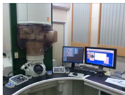
圖 10. 儀器完成安裝 CCD 和 EDX
