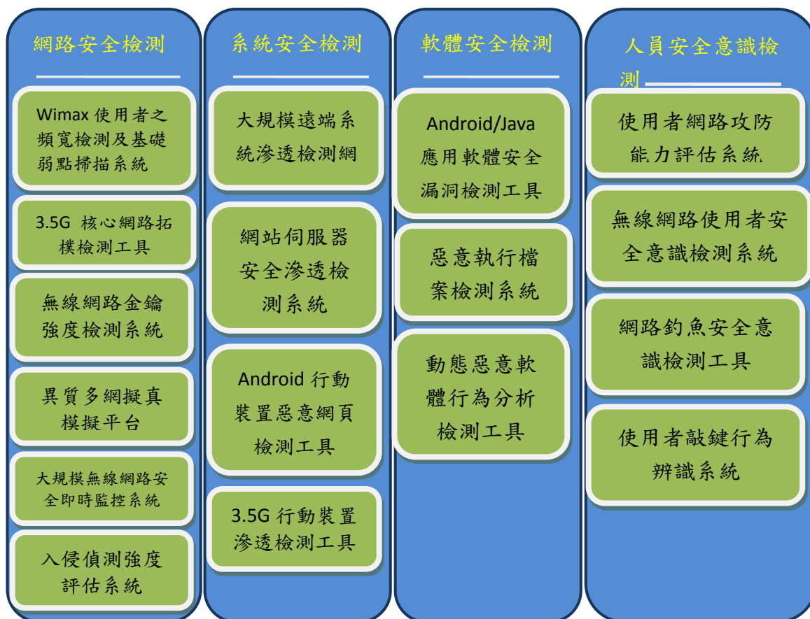
圖 4-1、2010 年異質多網安全檢測平台之架構圖
