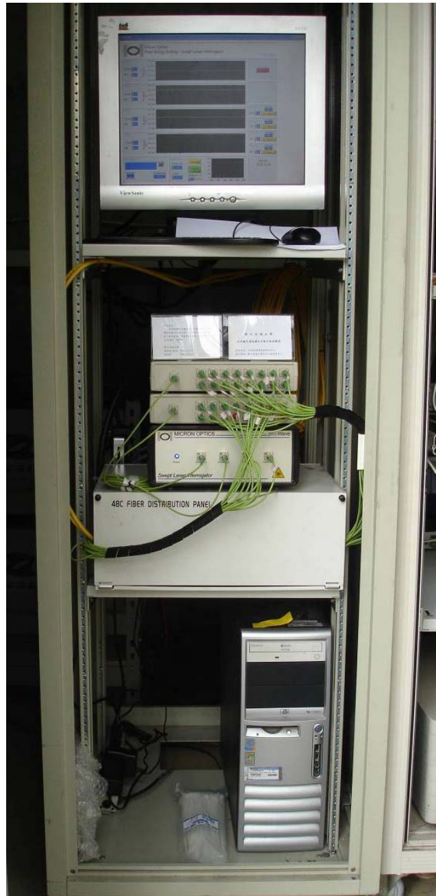
圖 3.14 現場光纖監測儀器擷取系統圖
