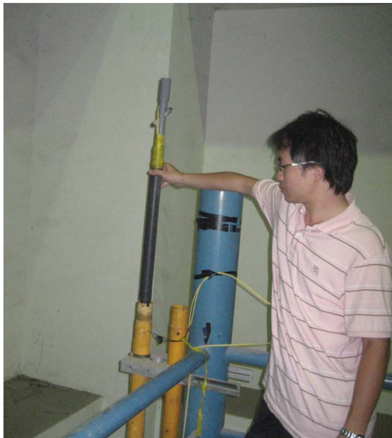
圖 2.32 光纖拉伸計架設於室內九米傾斜觀測管
