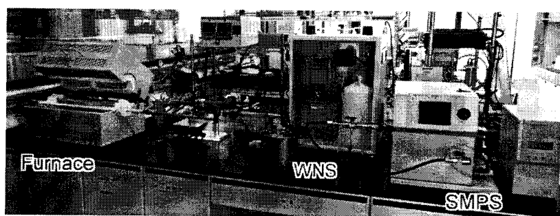
圖 3.14 蒸發-核凝奈米微粒產生方法之篩選平台的實際照片。
