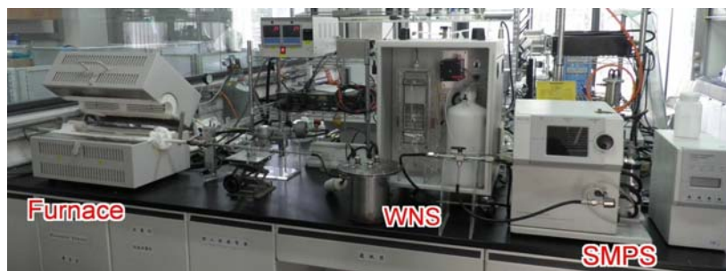
圖 3.14 蒸發-核凝奈米微粒產生方法之篩選平台的實際照片。
