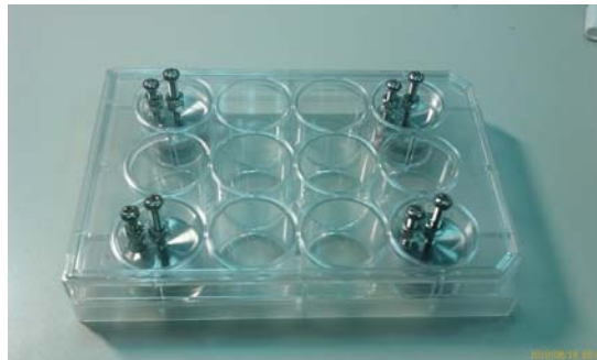
圖 3.15 市售細胞培養皿加工成可外加電場的電泳沉積設計。
