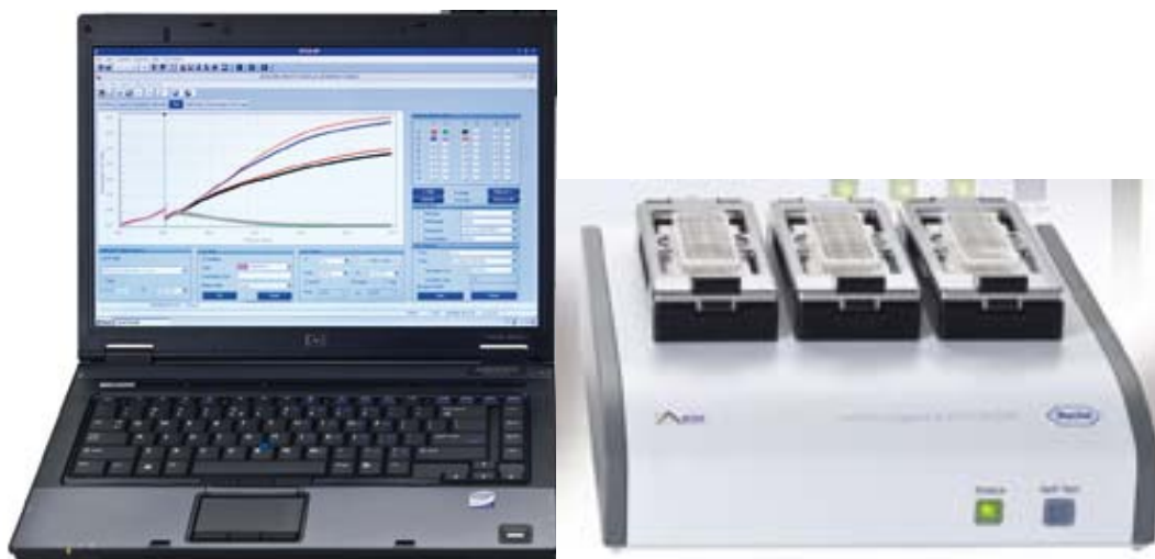
圖 3.17 細胞連續及即時生長分析儀主體及電腦偵測台。
