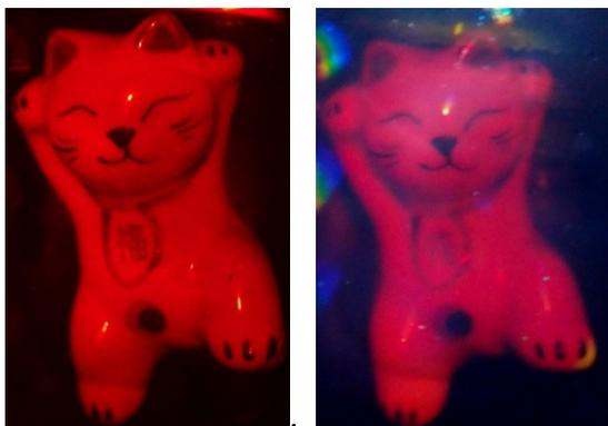
圖 2 重建影像: 左圖紅光 LED，右圖白光 LED
