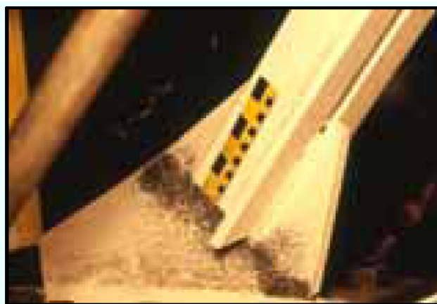
圖 2.1 含 2t 鉸區域長度之接合板凹折變形情況 (Astaneh-Asl et al. 1982)
