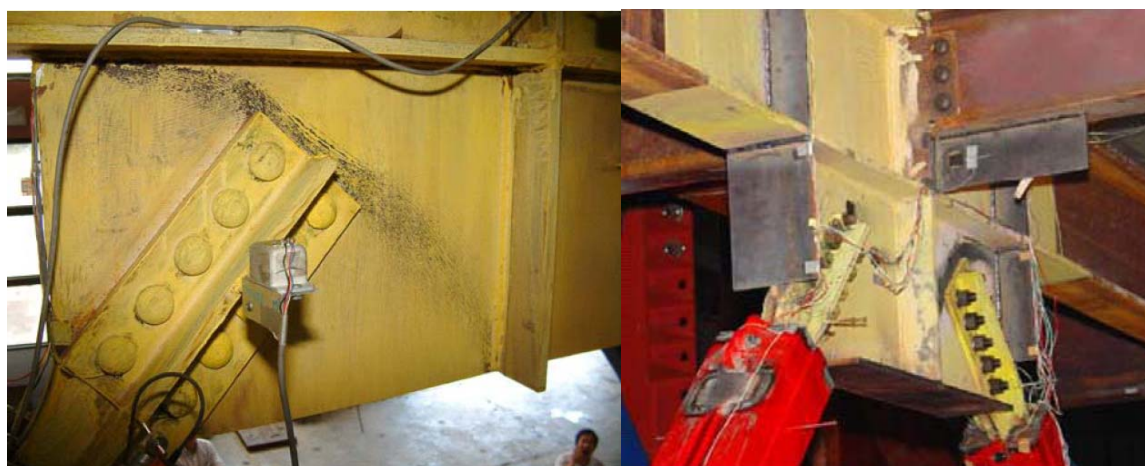
圖 2.10 與挫屈束制支撐之接合板產生挫屈之情況
