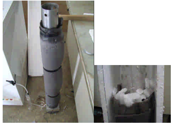
圖 2 土壤試管外隔熱泡棉與乾冰冰凍
