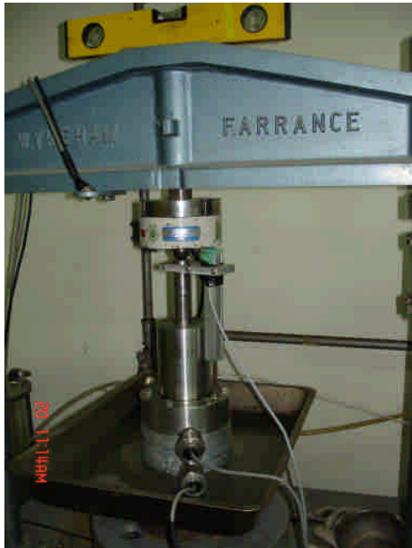
圖 5 組合架設完成之壓密儀
