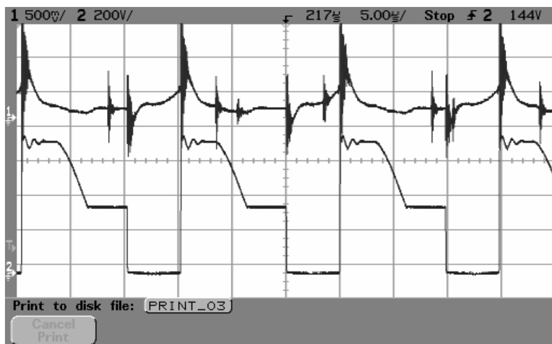
圖 4-7 ETD 44 變壓器鐵心共構實驗電路，負載 300W
