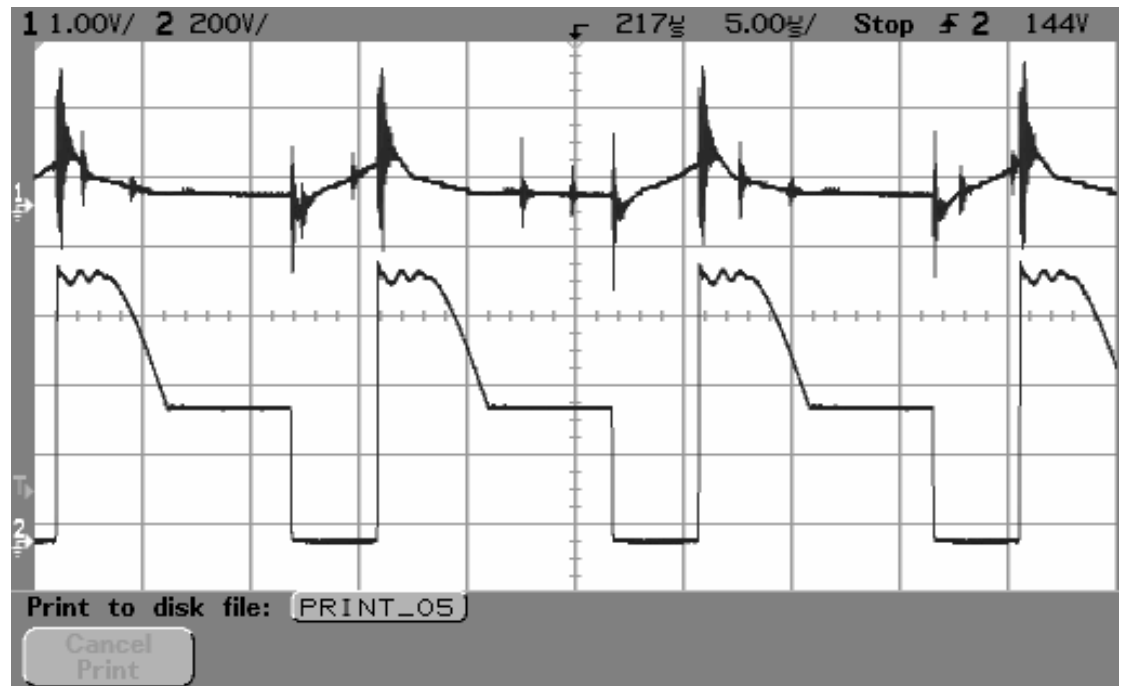
圖 4-8 ETD 44 變壓器鐵心共構實驗電路，負載 500W
