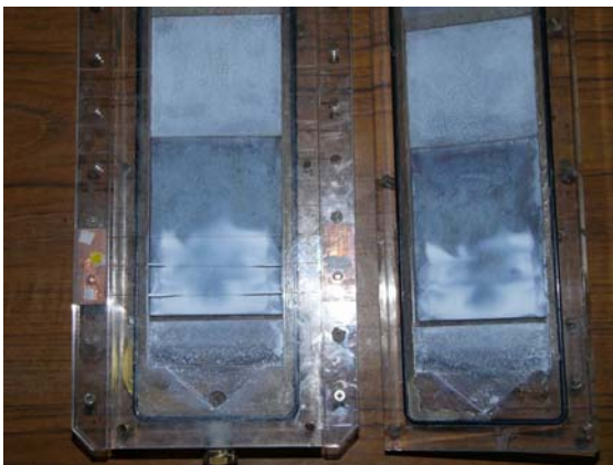
圖 34 乾式靜電集塵器粉塵負荷照片。 負荷時間為 30 分鐘。
