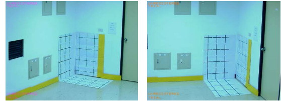
(圖 1) 校正物在左右兩台攝影機中的成像
