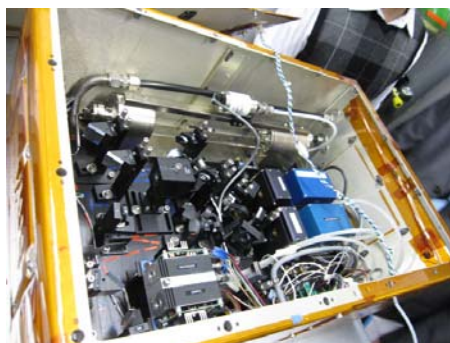
圖 8 以雷射技術即時連續監測大氣中各項氣態污染物之設備
