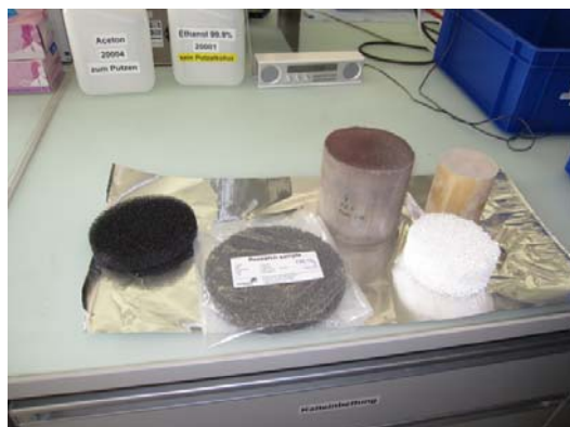
圖 3 柴油引擎使用之紊流型態之觸媒轉化器（圖中前面三塊自左至右分別為黑色、灰色及白色之觸媒轉化器）
