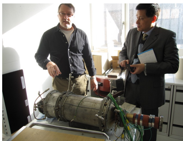
圖 4 EMPA 柴油引擎實驗室主任為參訪團隊解說，圖中 設備左邊為觸媒轉化器，右接粒狀物捕集器
