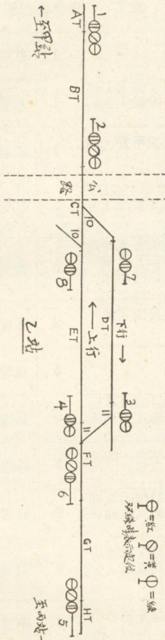
下圖車站乙為一單線之中途小站。其所有號誌及轍叉均係全繼電聯鎖裝置，並由號誌樓上之管理人員藉轉動照明盤上之電鈕以操縱之，本站之正線及蟾線（Loop）皆可進車及開車。但同時進車時則規定下行車進入蟾線，上行車進入正線。正線及蟾線皆設有安全岔道以防止列車衝出。號誌之名稱如下：
